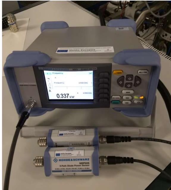
Figura 3. Medidor de potencia Rohde & Schwarz NRP50S
