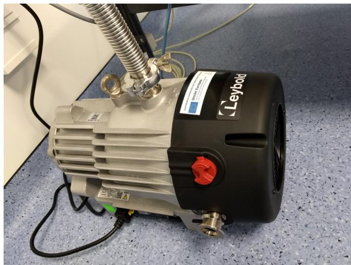
Figura 2. Bomba de vacío Scrollvac 10 plus 1-ph
