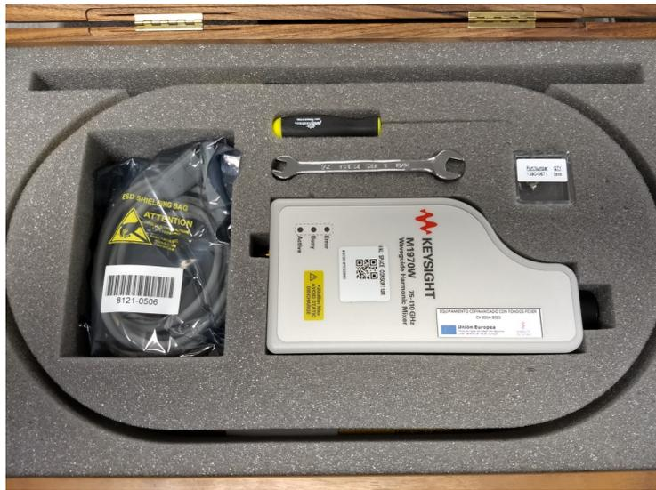
Figura 8. Mezclador de señales de radiofrecuencia en guía de onda
